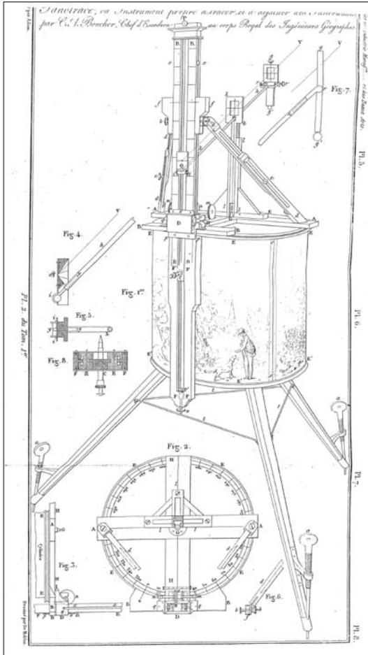
**Fig. 4** “Panotrace, ou Instrument propre à tracer et à dessiner des Panoramas, par C.A. Boucher, Chef d’Escadron au corps Royal des Ingénieurs Géographes” Drawn by De Moléon. *Annales de l’Industrie Manufacturière, Agricole et Commerciale de la salubrité publique et des Beaux-Arts* 1 (1827), second plate.
